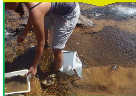
Phase d'éluviatriation (détermination de la taille des sédiments) sur la station Kaoris Aval le 3 janvier.
